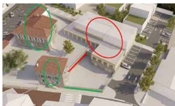
En rouge : Le bâtiment et le mur de soutènement à créer En vert : Les ouvrages existants conservés
